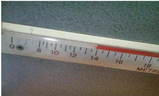
Gambar 6. Alat Ukur Kecepatan Aliran Udara Wind Tunnel
