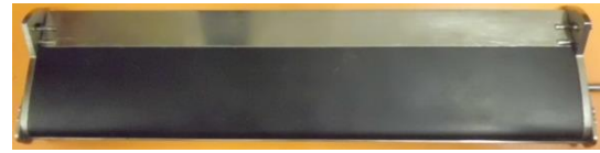
Gambar 8. Spesimen Uji Naca 0015
