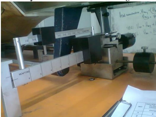
Gambar 7. Mistar Ukur Gaya Angkat dalam Wind Tunnel
